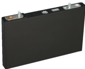
次世代蓄電デバイス (イメージ) 寸法：幅 150mm×奥行 15.8mm×高さ 93.2mm
